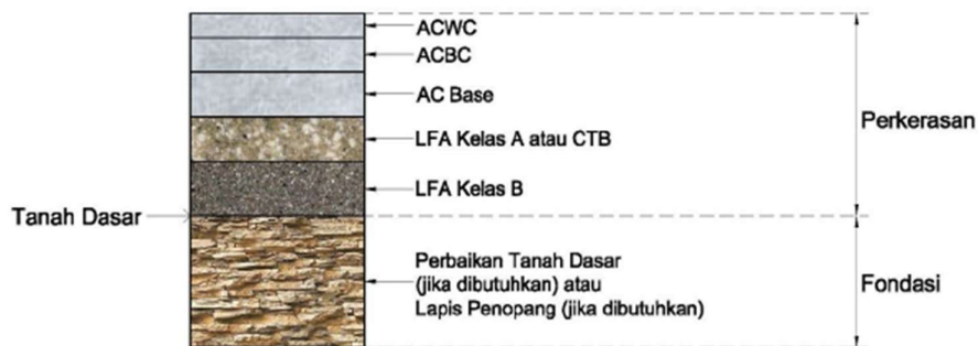
Gambar 2.9 Struktur Perkerasan Lentur Pada Tanah Dasar.
