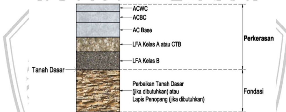
Gambar 2.11 Struktur Perkerasan Lentur Pada Tanah Galian.
