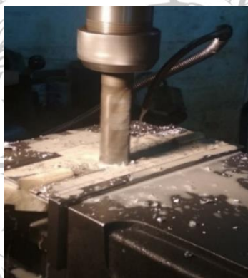
Gambar 3.20 Proses Pembuatan Spesimen Uji Tarik Standar ASTM E8
